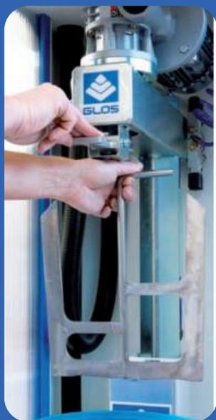
El batidor de mezcla cuenta con un sistema de **acoplamiento y desacoplamiento** rápido tipo bayoneta.
