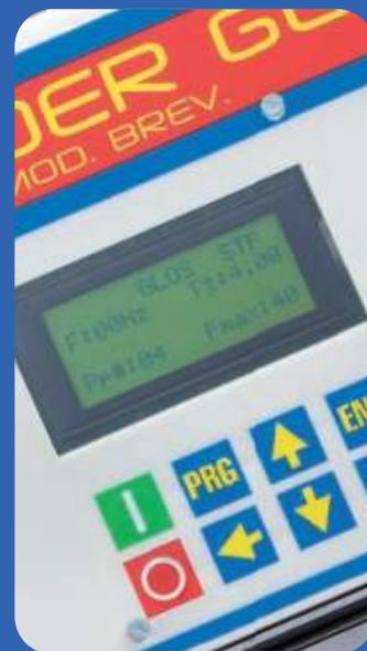
El panel de control, con tecnología electrónica, permite **seleccionar diferentes programas** según el producto a procesar.
