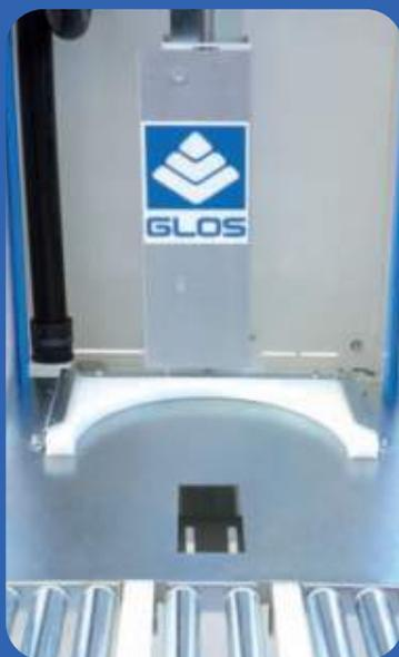
La posibilidad de elegir datos de diferentes diámetros permite un **centrado óptimo del cubo** de pintura.
